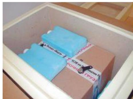
За счет малых габаритов и полной автономности прибор может быть установлен там, где применение других средств контроля невозможно. Прибор может работать во влажных и токопроводящих средах, и выдерживает воздействие большинства агрессивных сред и представляет собой одноканальный электронный самописец. Прибор обеспечивает накопление в собственной энергонезависимой памяти значений температуры с привязкой к реальному времени. Измеряет там, где установлен.
